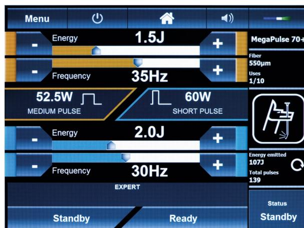
Le médecin expérimenté peut sélectionner lui-même la largeur d'impulsion du laser **MegaPulse 70<sup>+</sup>**, trois niveaux étant disponibles : courte, moyenne et longue ; une large gamme de 50  $\mu$ s à 1100  $\mu$ s est ainsi couverte.
